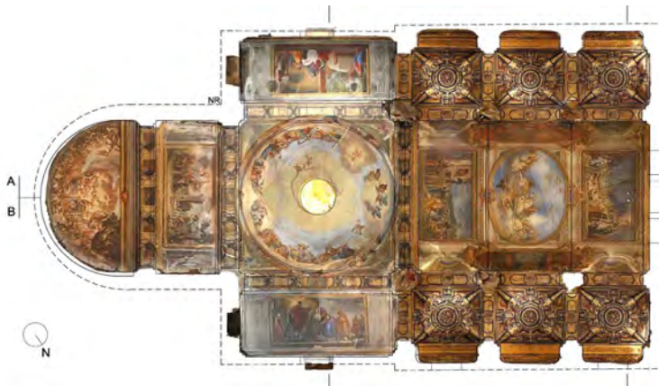
ORTOFOTO IN PIANTA CON RILIEVO AUTOCAD SOVRAPPOSTO
